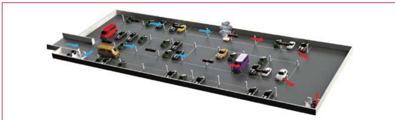
Wizualizacja funkcjonowania systemu GETAWAY w trakcie wykrycia pożaru w II strefie dymowej – rewersja
