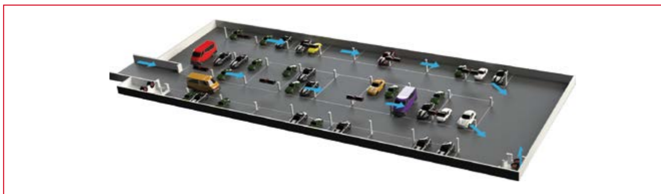
Wizualizacja funkcjonowania systemu GETAWAY w trakcie normalnego użytkowania – wentylacja bytowa
