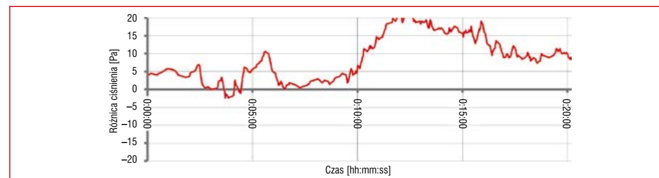
Rys. 3. Przyrost nadciśnienia w klatce schodowej wywołany zwiększonym napływem gazów pożarowych do klatki schodowej – wyniki badań obiektowych
