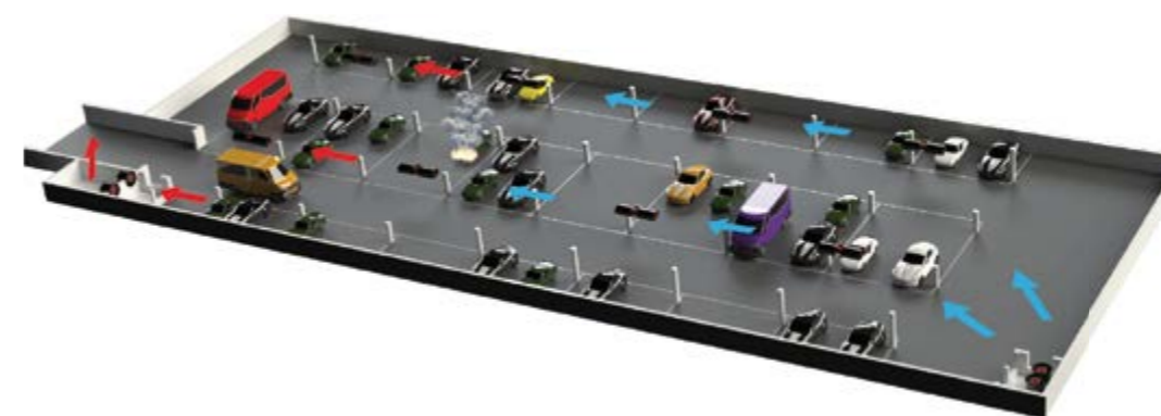
Wizualizacja funkcjonowania systemu GETAWAY w trakcie wykrycia pożaru w I strefie dymowej
