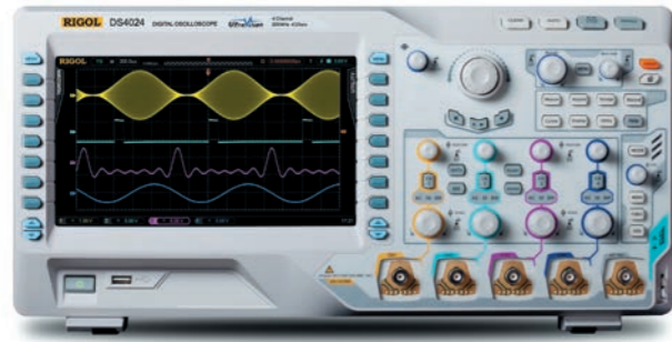
Cztery kanały umożliwiają jednoczesną obserwację kilku przebiegów
