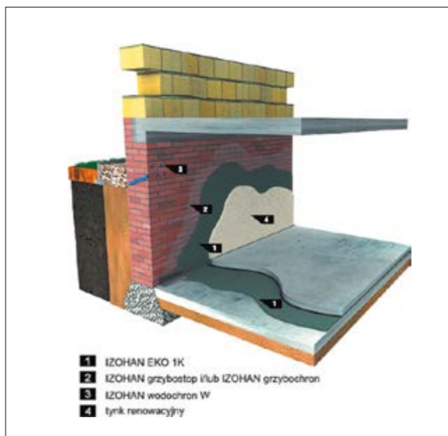
Renowacja zawilgoconych fundamentów w systemie IZOHAN
